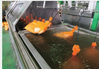
60度10分間浸漬後、冷却槽で冷やされる
