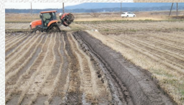
田んぼから水が漏れないように畦塗りをしている様子
