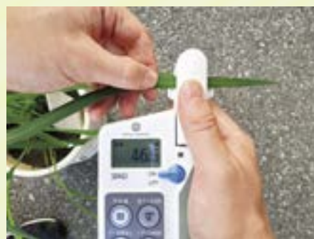
写真② SPAD測定
