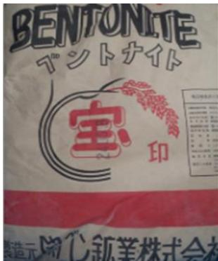
**「ベントナイト」とは** 土木工事を主体に漏水対策に用いられる素材で水分を含むと自体重の数十倍吸収し膨張する性質があります。土木では完全防水の為散布量や砂利等との混合比が決められています。水田は完全防水処理すると縦浸透が無くなり田面の肥料成分や上層の温かい水が浸透して地温を上昇させる効果が失われるのである程度の縦浸透も必要となります。
